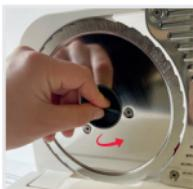
Enlevez la lame circulaire en la tournant dans le sens inverse des aiguilles d'une montre.
