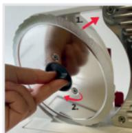
Затем тщательно протрите нож и дайте ему ещё немного времени, чтобы окончательно высохнуть на воздухе. Вновь вставьте дисковый нож и зафиксируйте его, повернув по часовой стрелке.
