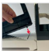
6. Inserire il carrello di guida nel binario della piattaforma di supporto.
