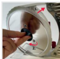
Nóż należy następnie dokładnie wytrzeć i przed montażem pozostawić jeszcze przez pewien czas do wyschnięcia. Założyć okrągły nóż (1) i zamocować go, obracając w kierunku zgodnym z ruchem wskazówek zegara (2).
