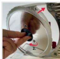
A continuación, seque bien la cuchilla y deje que se termine de secar al aire. Vuelva a insertar la cuchilla circular(1) y fíjela girándola en el sentido de las agujas del reloj (2).
