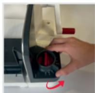
8. Mettere la leva di fissaggio per lo spessore di taglio in posizione 1 per allentarlo. Regolare poi lo spessore desiderato (0-26 mm) con l'apposito regolatore.
