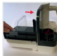
7. Τοποθετήστε το υλικό κοπής στην κινητή βάση και προσπιέστε το με τον συγκρατητή υπολειμμάτων.
