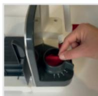
9. Zablokować dźwignię mocującą ustawnioną na wybraną grubość plastra w położeniu ②.
