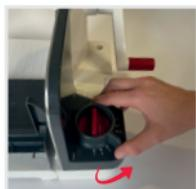
8. Colocar la palanca de bloqueo del grosor de corte en la posición para liberarla. Después, ajustar el grosor de corte deseado (0 - 26 mm) con el regulador.
