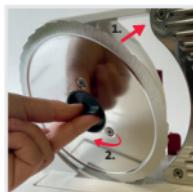
Trocknen Sie das Messer danach gut ab und lassen Sie es noch etwas an der Luft trocknen. Setzen Sie das Rundmesser wieder ein (1) und fixieren Sie es mit einer Drehung im Uhrzeigersinn (2).
