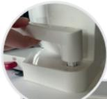
2. Inserire l'elemento della manovella nell'unità di misura. Far innestare in posizione con un clic.
