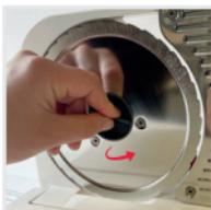
Entnehmen Sie das scharfe Rundmesser mit einer Drehung gegen den Uhrzeigersinn.
